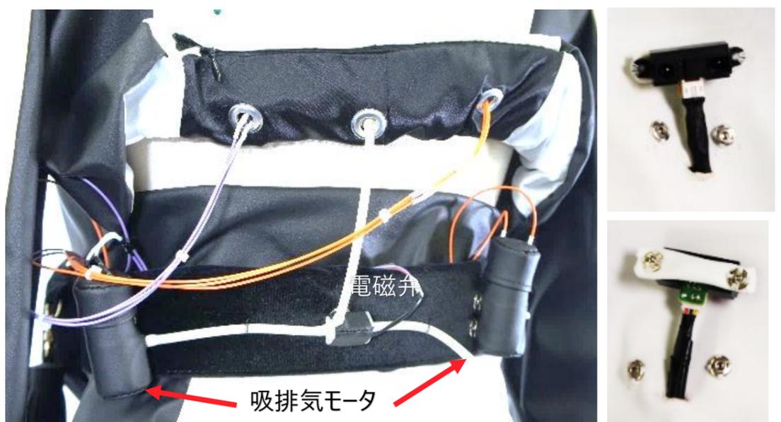
空気圧アクチュエータと赤外線距離センサの装着
